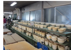
* 石膏に粘土を入れてローラーマシーンで作ります
