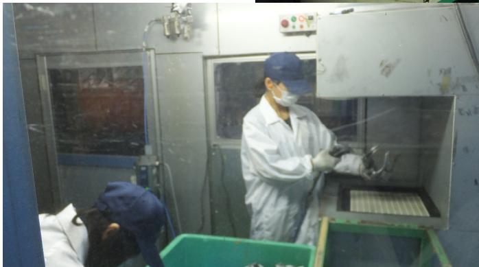
作業風景(施設外) 契約工場での塗装前のエアブロー作業
