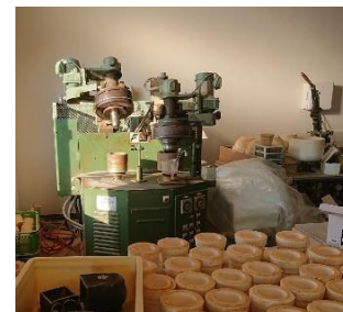
* 石膏に粘土を入れてローラーマシンで作ります
