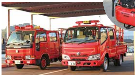
▲更新した小型動力消防ポンプ積載車(下)と小型動力消防ポンプ(右上)
